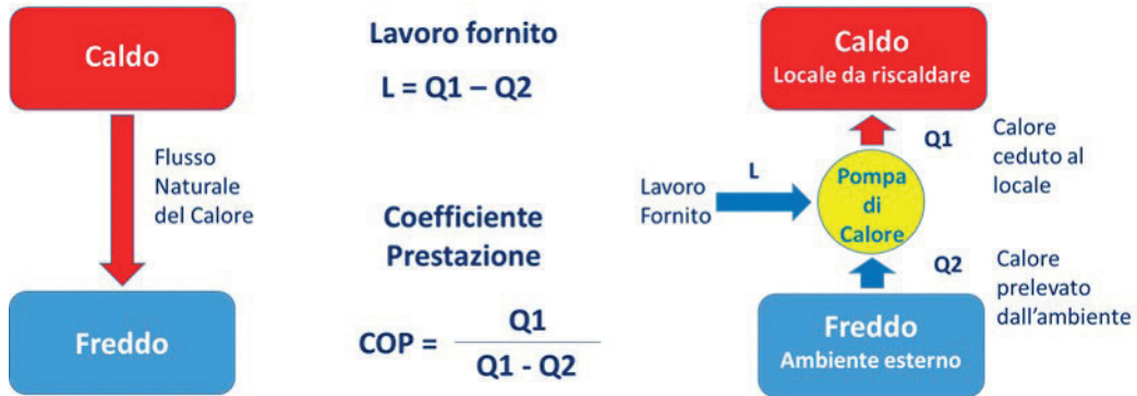
Figura 5 – Esempificazione del concetto di pompa di calore
